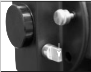
Fig. 31a : levier de commande du miroir basculant en position haute
