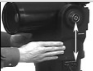
Fig. 29c [vue de côté] : .... jusqu'à ce qu'un des bras de la fourche soit juste au-dessus du panneau de contrôle.
