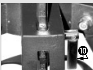
Fig. 13 : lecture du niveau de l'inclinaison
