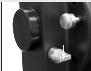
Fig. 3b : miroir basculant en position "basse".
