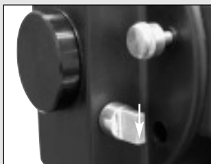
Fig. 3a : miroir basculant en position "haute".
