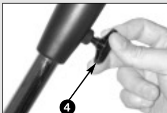
Fig. 9 : Réglage en hauteur d'une jambe du trépied
