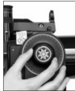
Fig. 16 : serrage du blocage vertical
