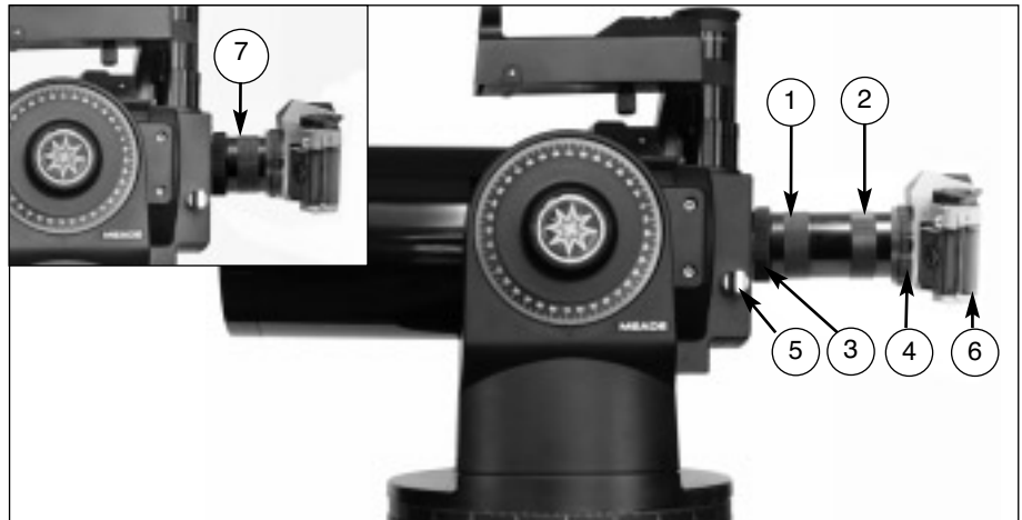
Fig. 30 : exemple de photographie avec l'ETX et un adaptateur T: (1) section courte de l'adaptateur en T #64 ; (2) section de l'adaptateur en T #64 ; (3) bague de fixation cannelée ; (4) Montage en T ; (5) Levier du miroir basculant en position haute ; (6) Boîtier reflex 35mm ; (7) Montage 1
