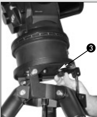
Fig. 46 : fixation de l'ETX au trépied
